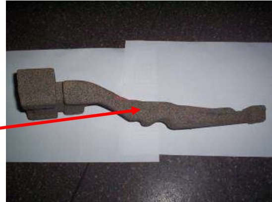
Şekil 3. 2.4 Litre Motor Blok yağ kanalında görülen sinterleşmiş kum.
