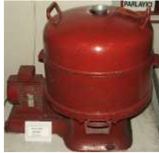
KALIP KUMU MİKSERİ KAPASİTE : 5 KG KUM
