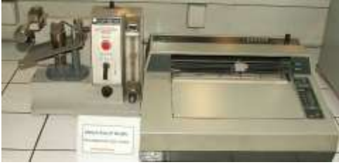
DEFORMASYON TEST CİHAZI (MAÇA VE KALIP KUMU)
