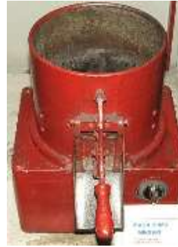
MAÇA KUMU MİKSERİ KAPASİTE : 2,5 KG KUM
