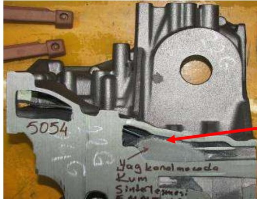
Şekil 3. 2.4 Litre Motor Blok yağ kanalında görülen sinterleşmiş kum.
