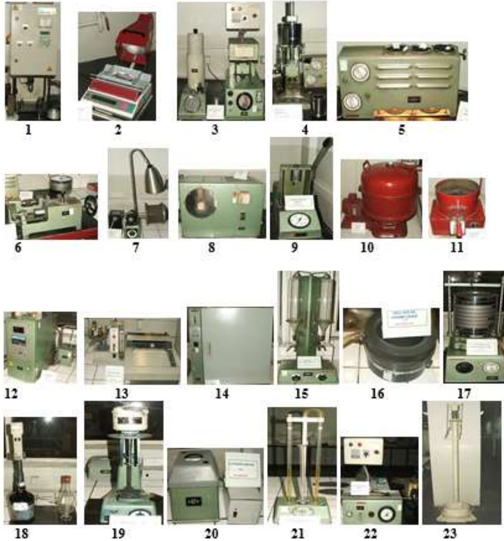
Şekil 9. 1.PVFC:Merkezi Test Ünitesi, 2. HNTC:Hızlı Nem Tayin Cihazı, 3. PDU ve PNZ: Gaz Geçirgenlik ve Isılak Çeşme Cihazı, 4. PRA: Uç Darbe Numune Hazırlama Cihazı, 5. PIT: Infra-Red Hızlı Nem Tayin Cihazı, 6. PFG: Hidrolik Mukavemet Cihazı, 7. PMT: Moldabilite Cihazı, 8. Sinter Fırını, 9. PVG: Kompaktibilite Cihazı, 10. Kalıp Kumu Mikseri(5 Kg), 11. Maça Kumu Mikseri(2.5 Kg), 12. PDL: Dilatometre Cihazı, 13. Deformasyon Test Cihazı, 14. Etüv, 15. PKA : AFS Kil Yıkama Cihazı, 16. PSB: Hızlı AFS Kil Yıkama Cihazı, 17. PSA: Elek Analiz Cihazı, 18. PMK: Metilen Maviyi Aktif Kil Test Cihazı, 19. PWE: Hızlı Karıştırıcı(Agitatör), 20. PMS: Ultrasonik Karıştırıcı, 21. POF : Yüzey Köşelliliği Cihazı, 22. PCR: Sıcak Mukavemet Cihazı, 23. PST: Shutter Index Cihazı.
