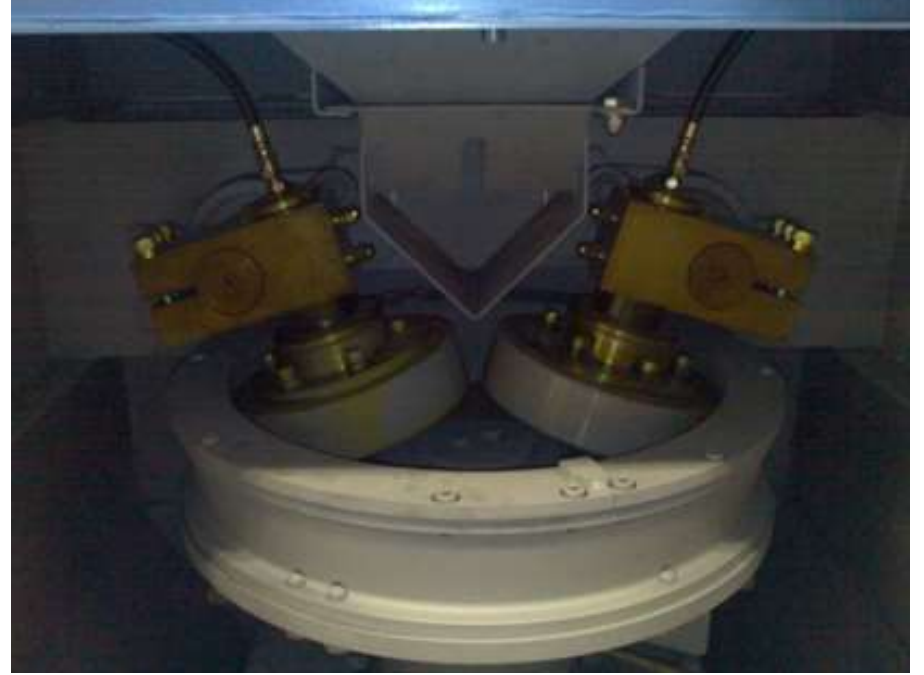
Şekil 3. Kum tanelerinin rejenerasyon edildiği disk ve tambur sistemi.
