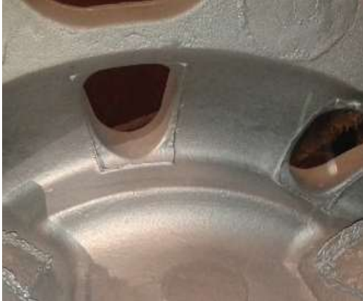
Kumlama sonrası üst derece döküm yüzeyi
