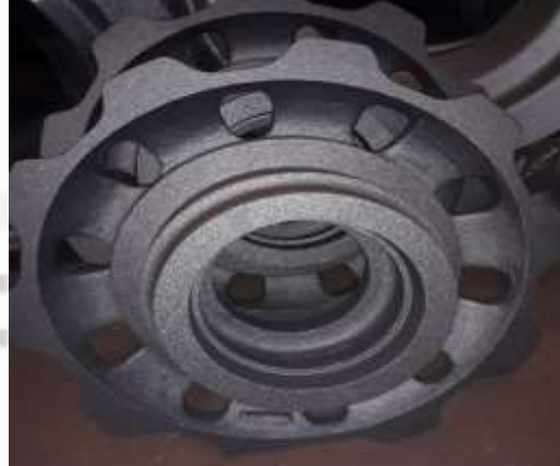
Ultrasonik ve MPI kontrolleri sonrası üst derece döküm yüzeyi
