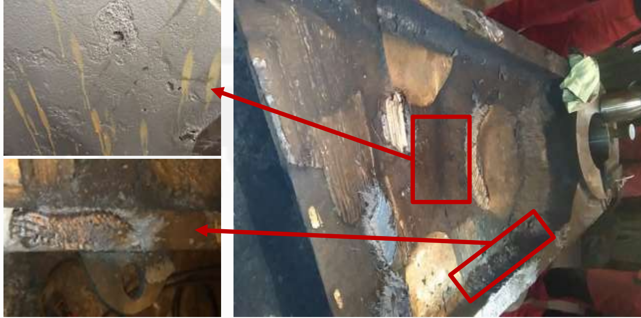
Üst yüzeydeki gaz ve kum inklüzyon hataları
