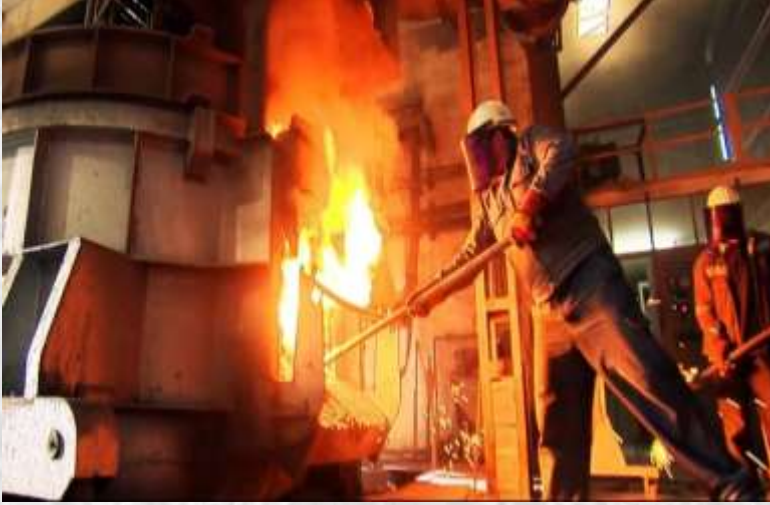
Akmetal Elektrik Ark Ocağı
