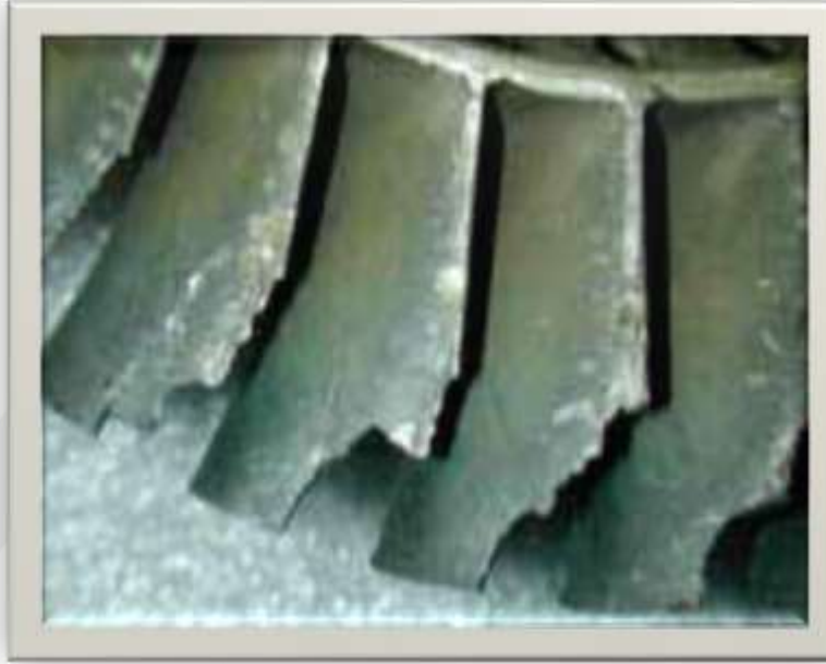
Türbin kanadında az akma
