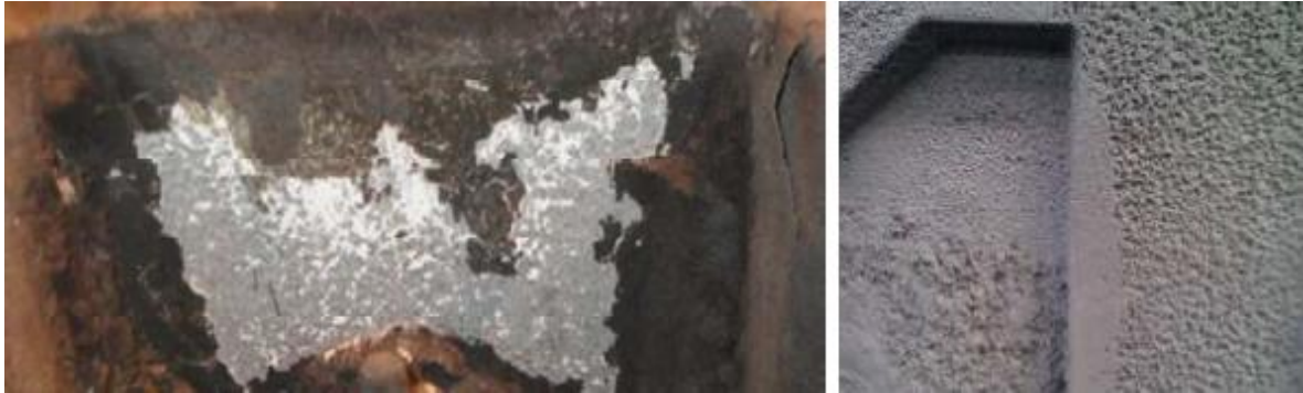
Şekil 3: Döküm yüzeydeki hatalar (a); hatanın ayrılması sonrasında döküm yüzeyinde etki (b)
