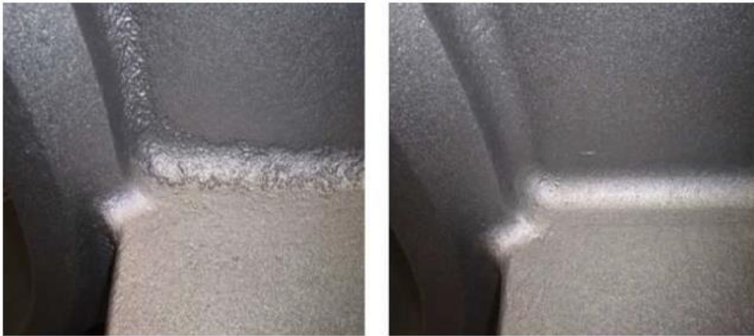
Şekil 14: Mangan emdirmesiz kaplama (solda), mangan emdirmesli kaplama (sağda). Üst katman olarak alüminyum-silisyat kaplama kullanılmıştır.
