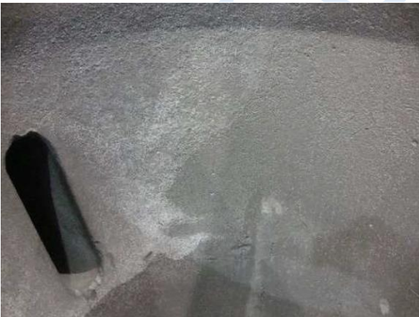
Şekil 13: Döküm yüzeyi, standarttan (solda) manganlı boya'ya geçiş (sağda)
