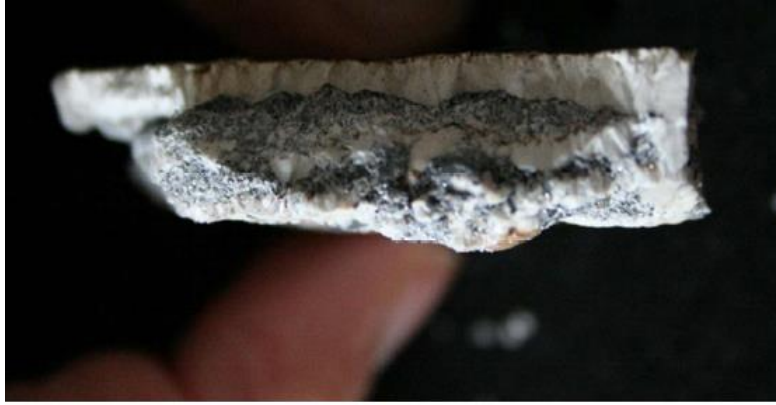
Şekil 2: Siyah inklüzyon ile beraber beyaz film halindeki döküm hataları
