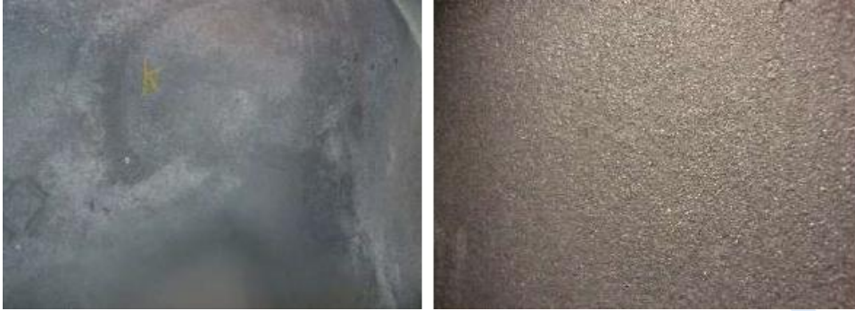
Şekil 9: Solda:furan reçineli sistem-geri kazanılmış kum ve zirkon bazlı kaplama Sağda:inorganik bağlayıcı sistemi-yeni kum ve zirkon bazlı kaplama
