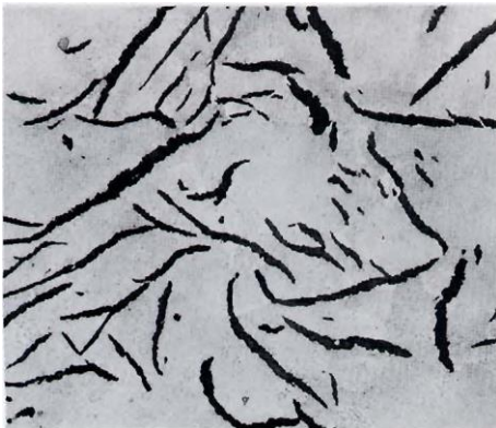
Şekil 7 - Azot pinhole hatasının grafitlerin yapısı ile ilişkisi. Şekil 8 - Azot Pinhole Hatası. Sıvı metal içinde çözülmüş Azot'a bağlı olarak ortaya çıkan Azot pinhole boşlukları, genellikle parçanın her bölgesine yayılmış olarak görülür. Maça bağlayıcılarına bağlı olarak ortaya çıkan hatalar ise genellikle parçanın maça yüzeylerinde görülür.
