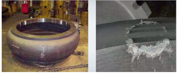
Şekil 6: Büyük bir sfero parçada (solda) ekzotermik besleyici gömleği altında bulunan yapraksı grafitler (sağda)
