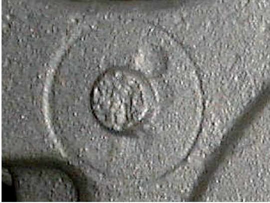
Şekil 9: Döküm parça üzerinde kırıcı maçanın izi (modelin aşınmasından kaynaklanmaktadır)
