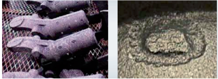
Şekil 7: Sfero parçada "Fish-eye" (Balık gözü) döküm hatası
