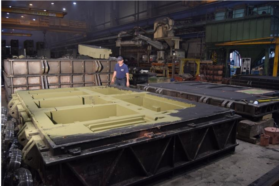
Fotograf 1 = Solitec HI 703 Uygulama sonrası renk değişimi ile kuruma seviyesinin tesbiti
