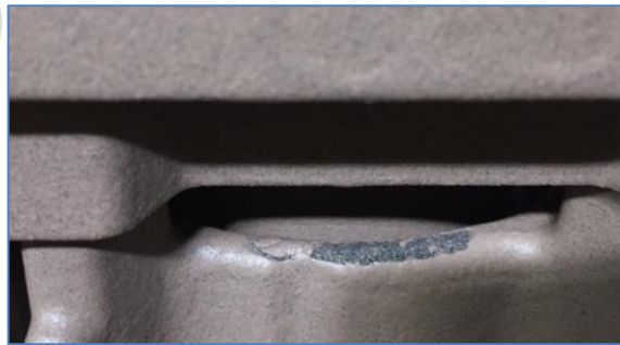
Fotograf 4 :Bakteri Üremesine bağlı, Maça Yüzeyinde Boya –Su ayrışması
