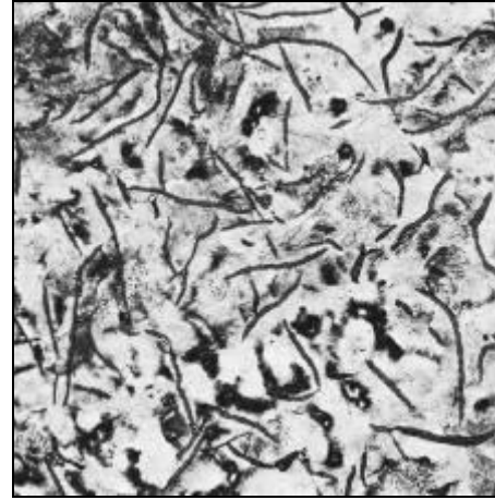
Şekil 2: A - tipi grafit ve gri katılaşmış lamel grafitli dökme demirin mikroyapısı
