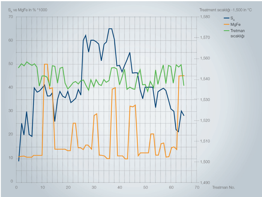
Şekil 13: Değişken ocak Kükürt miktarı ile sıcaklık da yapılan tretman sonuçları
