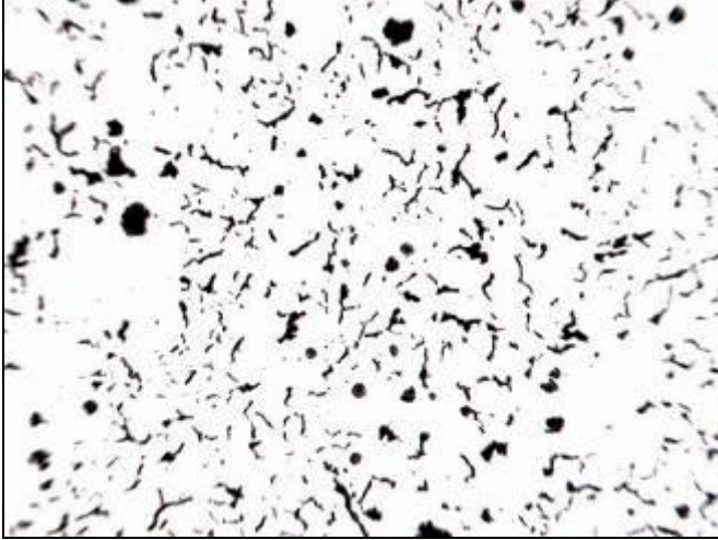
Resim 7: Örnek 2'de elde edilen CGI grafit yapısı, büyütme oranı 100:1, dağlanmamış
