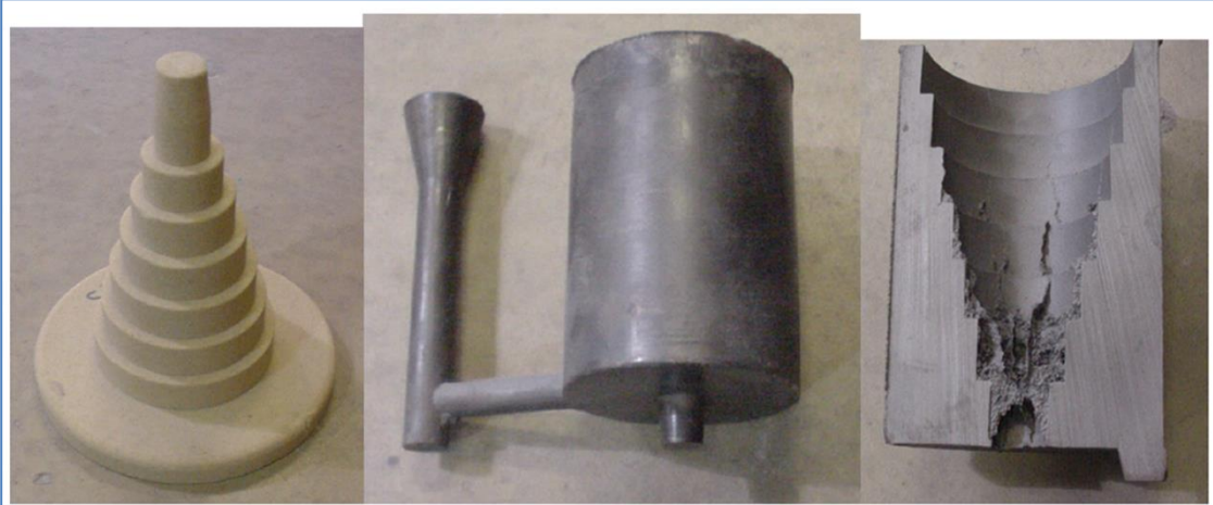
Şekil 2. Basamaklı koni maça (sol), döküm parça (orta) ve kesiti (sağ)
