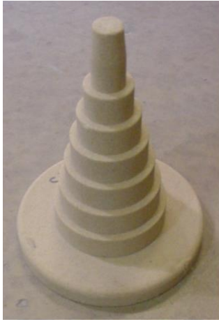
Şekil 2. Basamaklı koni maça (sol), test dökümü (ortada) ve kesiti (sağ)
