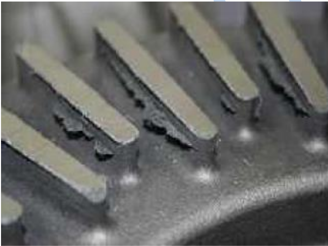
Şekil 4. Damarlaşma hataları görülen fren diski parçası
