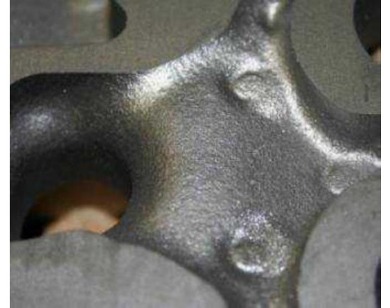
Şekil 7. MIRATEC TS kullanılan döküm parça yüzeyi
