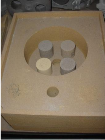
Şekil 3. 2x2 maça ve kalıp (sol), damarlaşma hatalarının görülebildiği parça kesiti (sağ)
