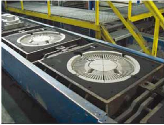
95 % silica sand + 5 % ESA 2011, 1,6 % cold box 419/619
