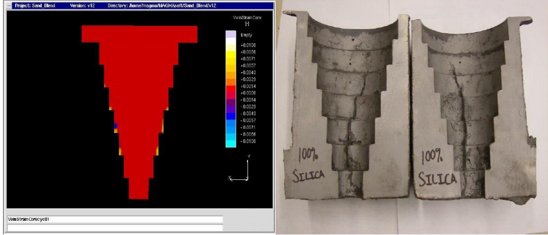
Şekil 10. Silis kumu simülasyonunun çelik basamaklı koni test dökümü ile karşılaştırılması
