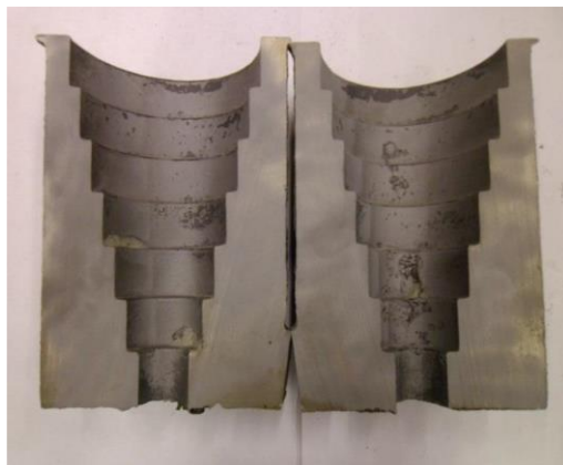
Şekil 14. %3 kırmızı demir oksit simülasyonu ile basamaklı koni çelik döküm numunesi karşılaştırması
