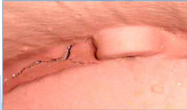
Resim 2 : Strafor model üzerinde, boya kurutma işlemi sonrasında boya çatlama problemi. (Uygulama kalınlığı yaklaşık \approx 2,70 \text{ mm} ) kuru hava ile kurutma ve hava sıcaklığı 40 \text{ } ^\circ \text{C} .
