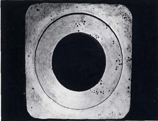
Şekil 3 - Yüzet altında Oluşmuş Hidrojen Pinhole hatası . Hata Parça işlendikten sonra hata ortaya çıkmış
