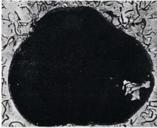
Şekil 1- İçi grafit kaplı Hidrojen Pinhole Hatası X 100 Picral
