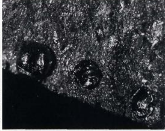
Şekil 2- Hidrojen Pinhole Hatası -Boşlukların içi parlak ve siyah
