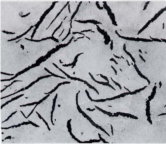
Şekil 7- Azot pinhole çevresindeki grafitlerin yapısı
