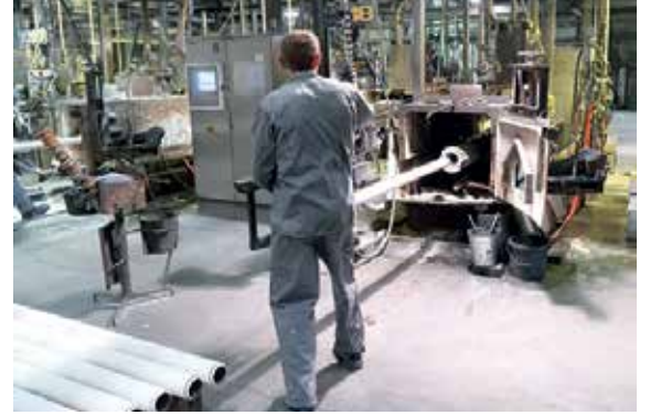
▲ Kokil kalıptan tamamı sıyrılan ve boruya yapışan boya
