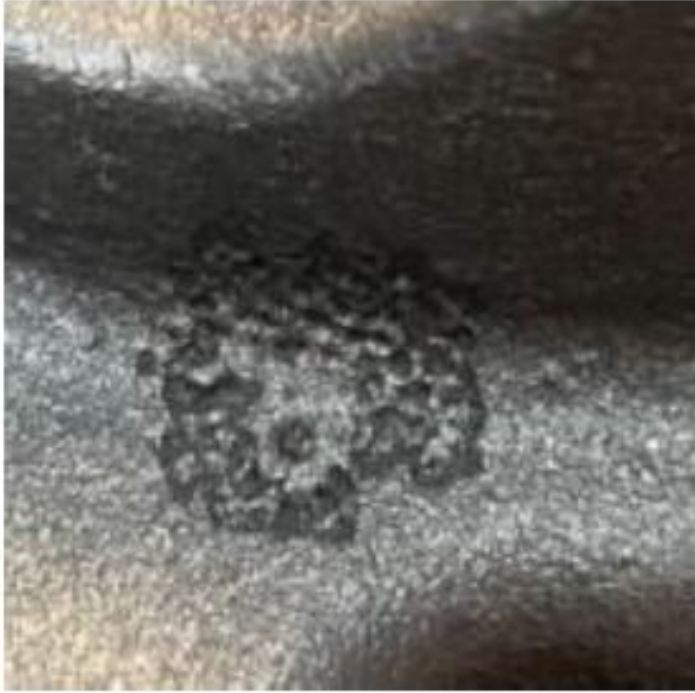
Şekil 10. Flor Hatasından Kaynaklanan Balık Gözü Hata Görünümü
