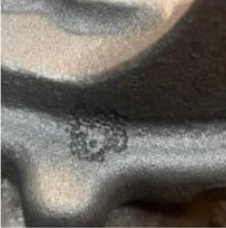
Şekil 8. Flor Hatasından Kaynaklanan Balık Gözü Hata Görünümü
