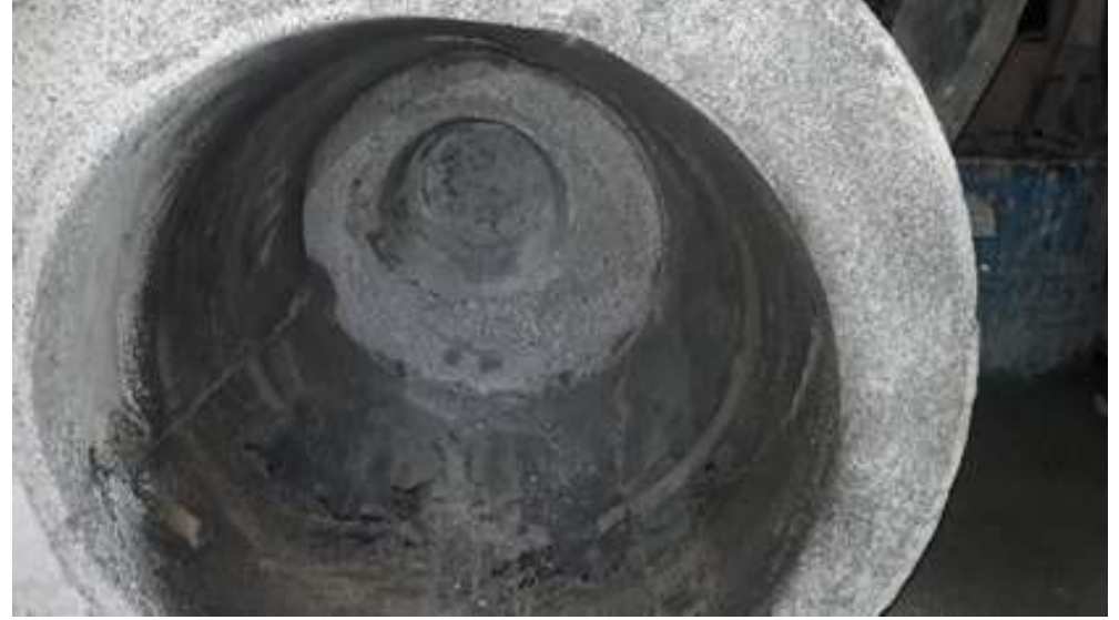
Şekil 5. Yeni nesil EKW Focor LPN refrakter malzeme ile astalama sonrası sinterleme ve şablon sökümünden sonraki astar yapısı
