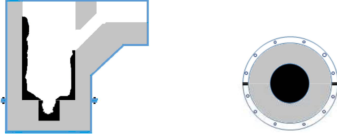
Şekil 1. Ocak önü tretmanı standart pota yeniden refrakterleme adımları
