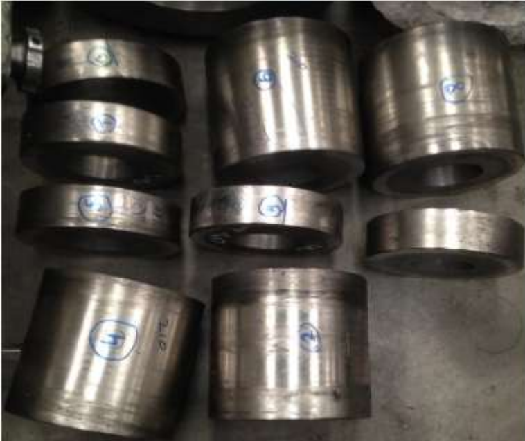
Şekil 1: Tel erozyon yöntemi ile dilimlenen kırıcı merdane
