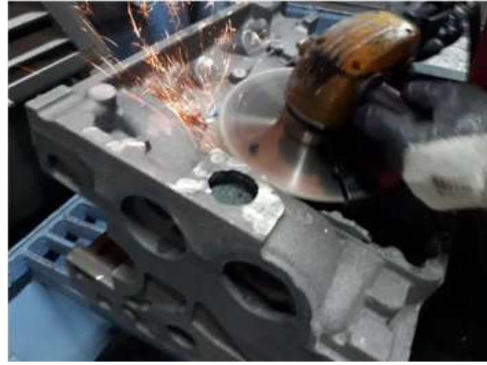
Şekil 6 ( Iveco motor blok taşlama )
