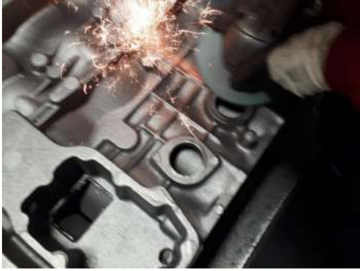
Şekil 5 ( Iveco motor blok taşlama )
