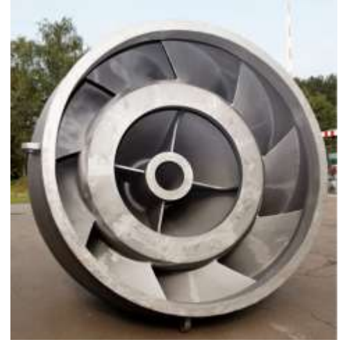
Vana kılavuz parçası GJS 400, ağırlık yak. 7 ton
