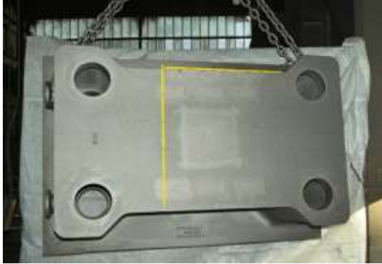
Tezgah makinası parçası GJS 400-18 Yüksek yüzey kalitesi
