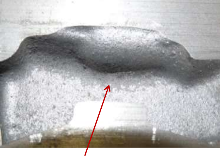
Döküm para yüzeyine boyanın yapışması
