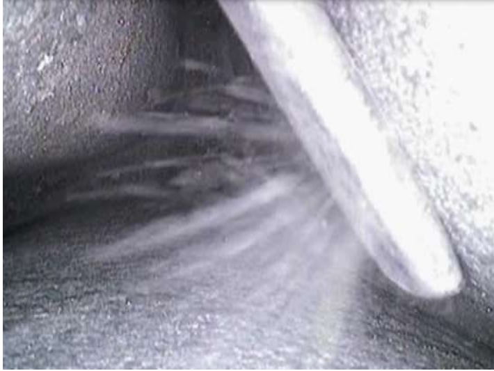
Döküm parça yüzeyi aşındırıldığında çıkan yüksek toz düzeyi
