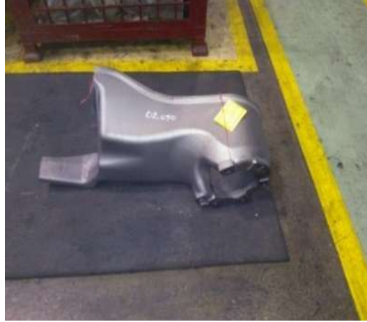
Şekil 4. Ağırlık azaltma projelerinden traktör egzost muhafazası. SSF 14 (EN-GJS-500-14) malzemedен seri olarak üretilmektedir.
