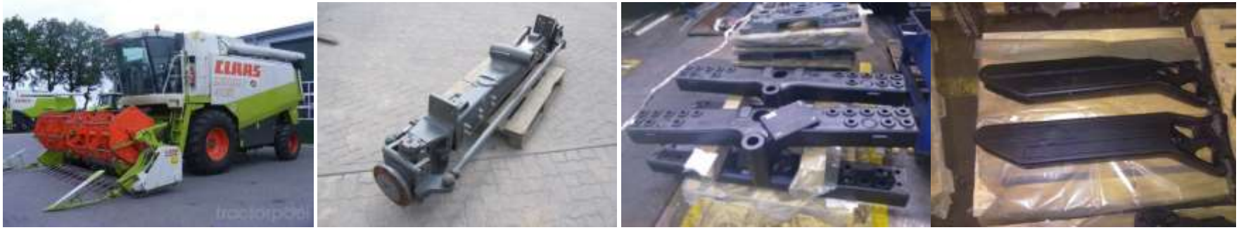
Şekil 1. Yeni nesil sfero dökme demirlerden üretilen biçerdöver tarım makinesinde kullanılan arka aks dingili parçalarının montajsız ham ve montajlı fotoğrafları.
