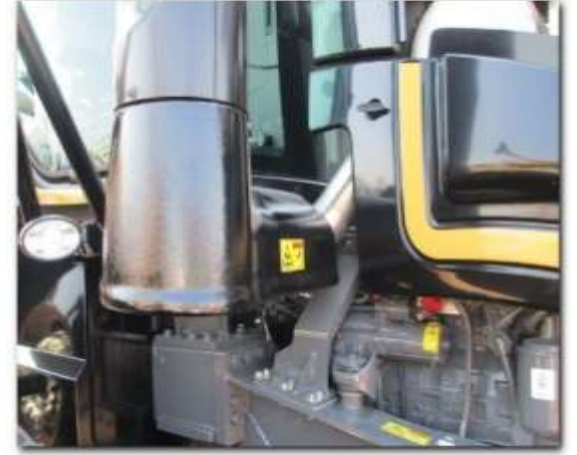
Şekil 4. Ağırlık azaltma projelerinden traktör egzost muhafazası. SSF 14 (EN-GJS-500-14) malzemedен seri olarak üretilmektedir.
