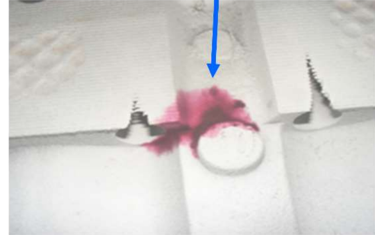
Sıvı penetrant tahribatsız muayenesi uygulanmış vaka-2 numunesinin üzerinde bulunan destek bölgelerinin test sonrası görünümü
