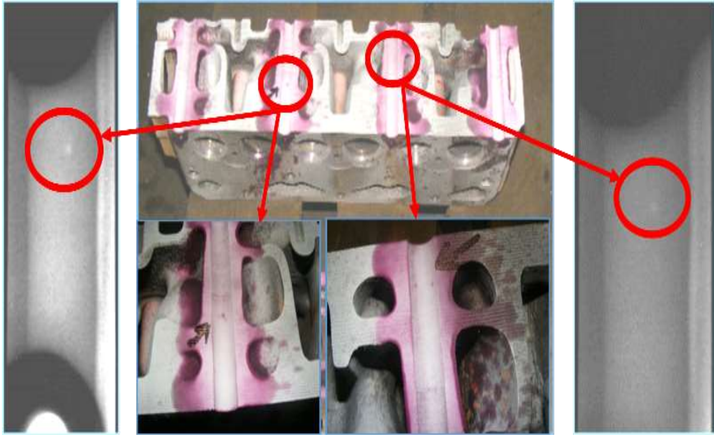
Motor blok kafasının yatay bölgesinden alınan parçanın hasarlı bölgesinin X-ışını radyoskopisi görüntüsü
