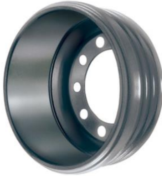
Dışı çelik saç, fren yüzeyi savurma dökme demir ağır vasıta fren kampanası
