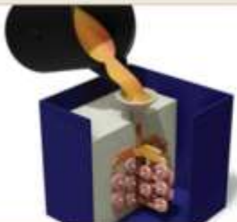
8. Abgießen Pouring Coulée
