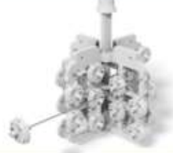
4. Gießtrauben montieren Cluster assembly Assemblage en grappe
