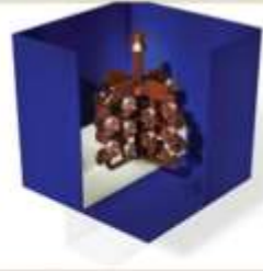
10. Aussanden Demoulding Démoulage
