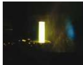
Çapraz delik geometrili nozülden döküm akışı görünümü
