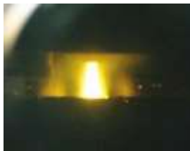
Konvansiyonel nozülden döküm akışı görünümü
