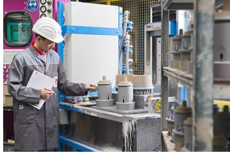
+GF+ Dökümhanesinde çalışan daldırma tankı ve Manipülâtör
