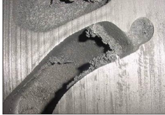
Damarlaşma Hatası- Veining
