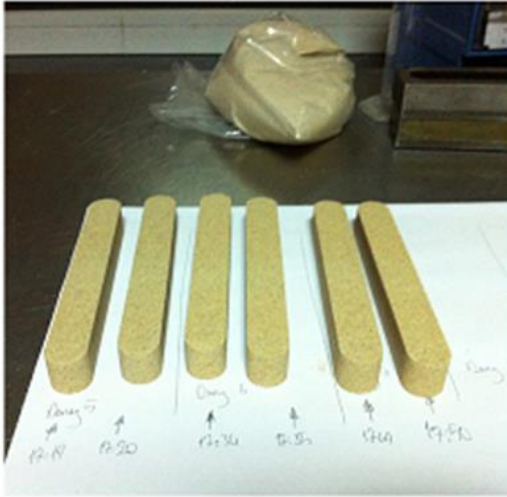
Laboratuvar şartlarında üretilen maça çubuklarında mukavemet testi
