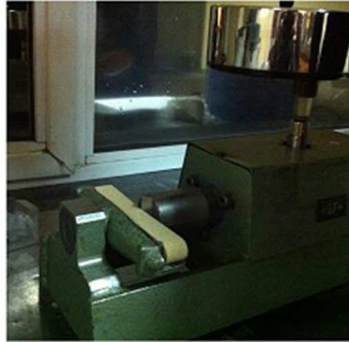
Laboratuvar şartlarında üretilen maça çubuklarında mukavemet testi
