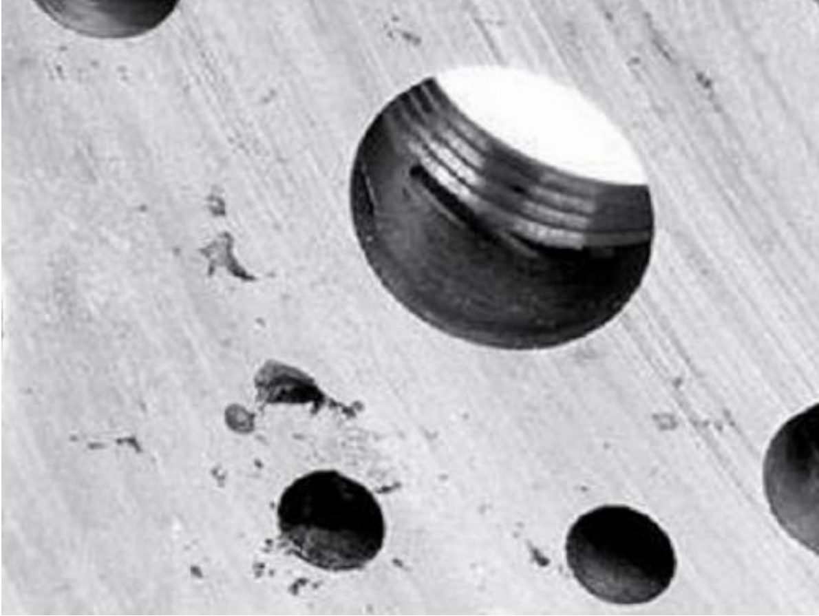
Şekil 2. İşlenmiş yüzeyde görünür iç porozite
