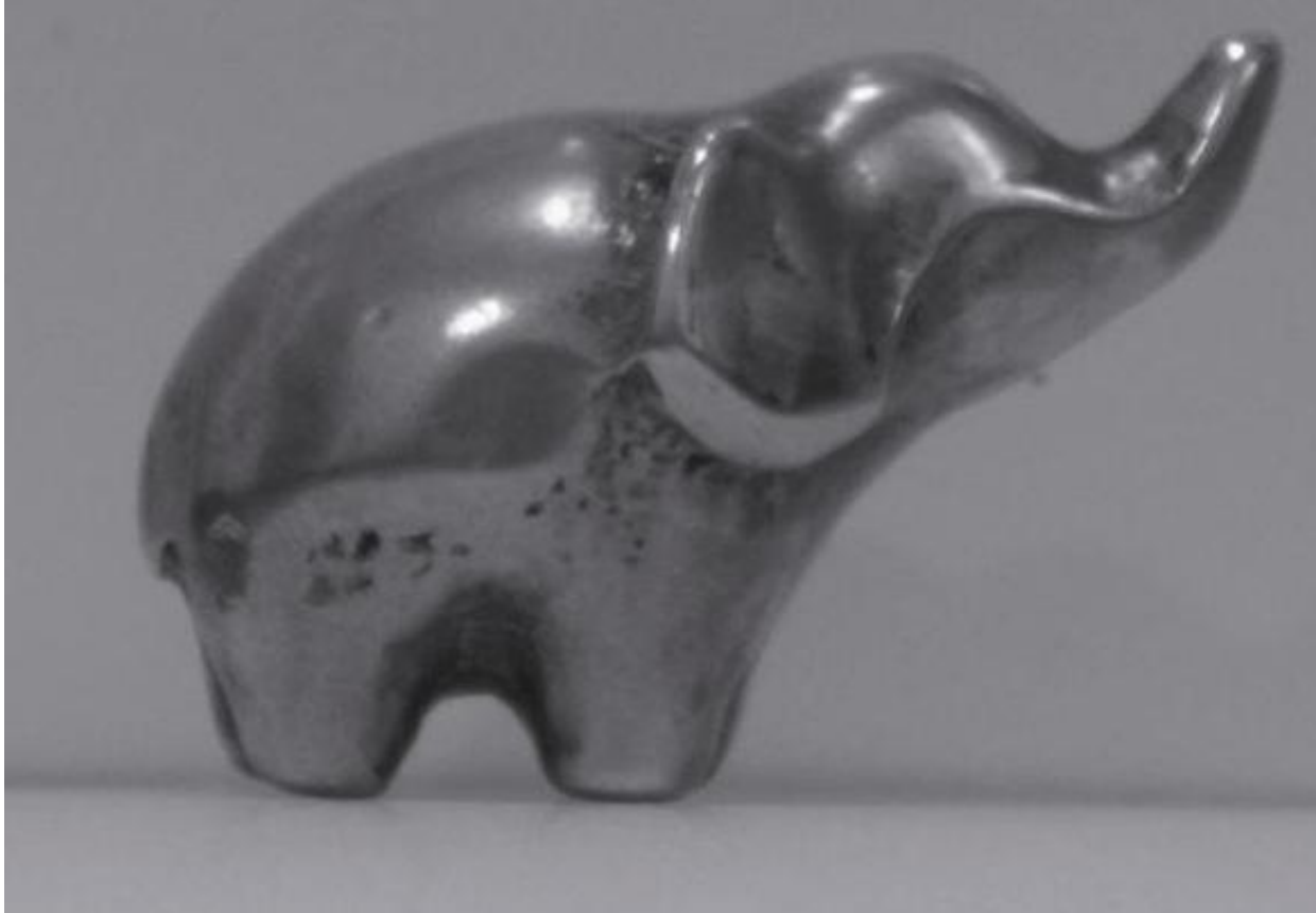
Şekil 1. Döküm parça üzerinde görünür yüzey porozitesi
