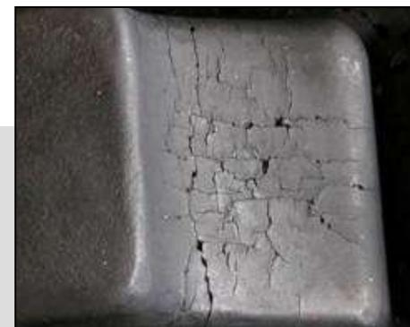
**Häufigste Ausfallursache von Druckgussformen sind Brandrisse durch die Thermowechselbelastung**
