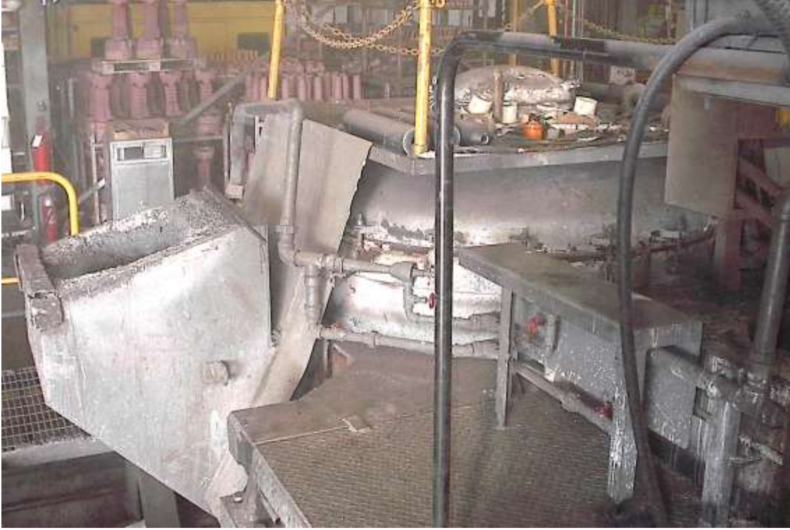
Figür 2: Otomatik Döküm Ocağı (Yükleme ağızı)
