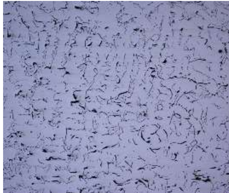
Seri üretim şartlarında (potaya Ferro Mangan Affine ilavesiz – aşılı) ayrı döküm çekme çubuğu numunesi mikroyapısı
