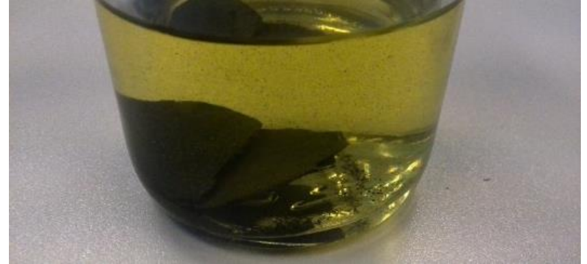
Motor soğutma sıvısında biriken partikül miktarı
