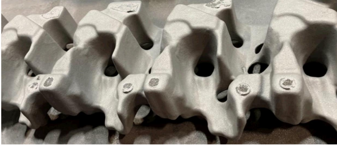
Motor silindir kafasında İç Temizlik Boyası uygulaması
