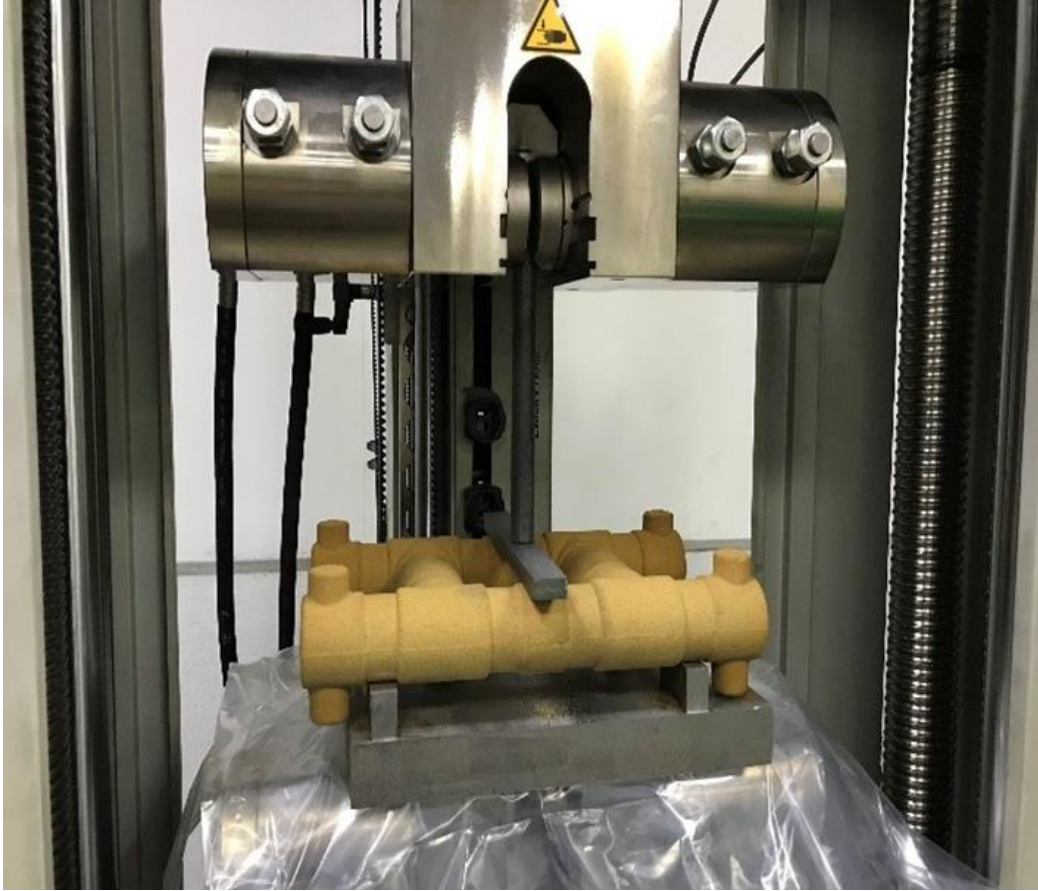
Resim 5: Basma testi ile maça mukavemetlerinin kontrol edilmesi
