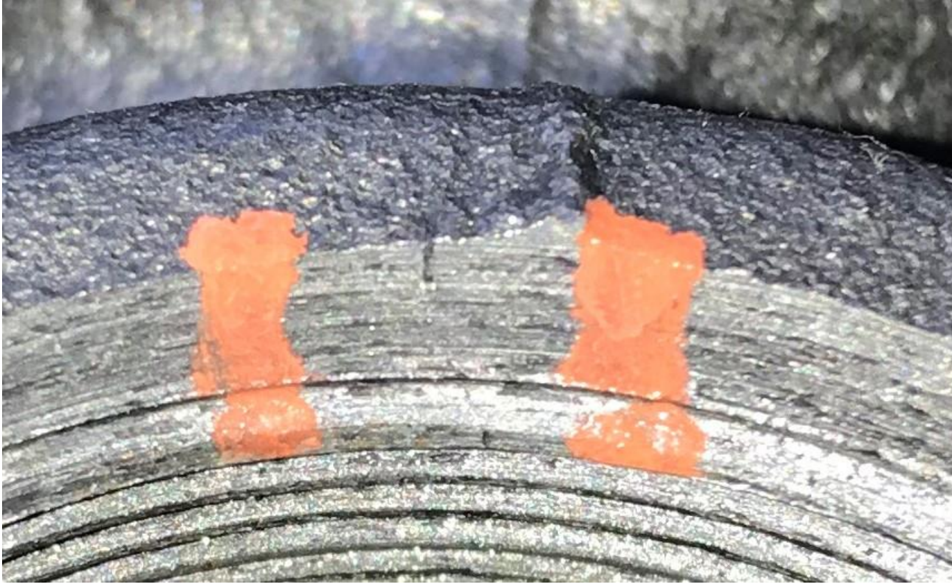
Resim 4: Diş açılmış boru ekleme parçasında sıcak yırtılma hatası
