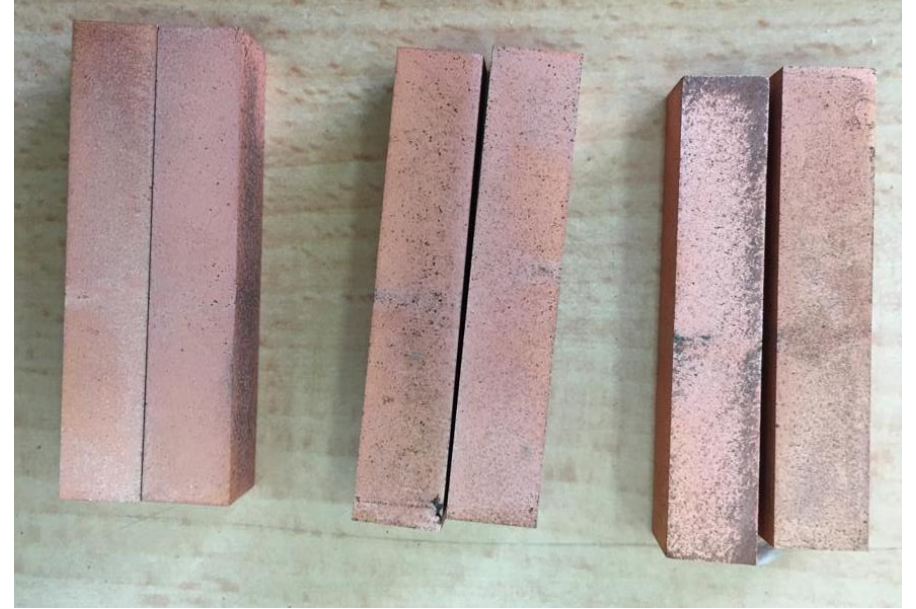
Östempereleme ısıtıl işlemi için bakır kaplanmış darbe testi numuneleri
