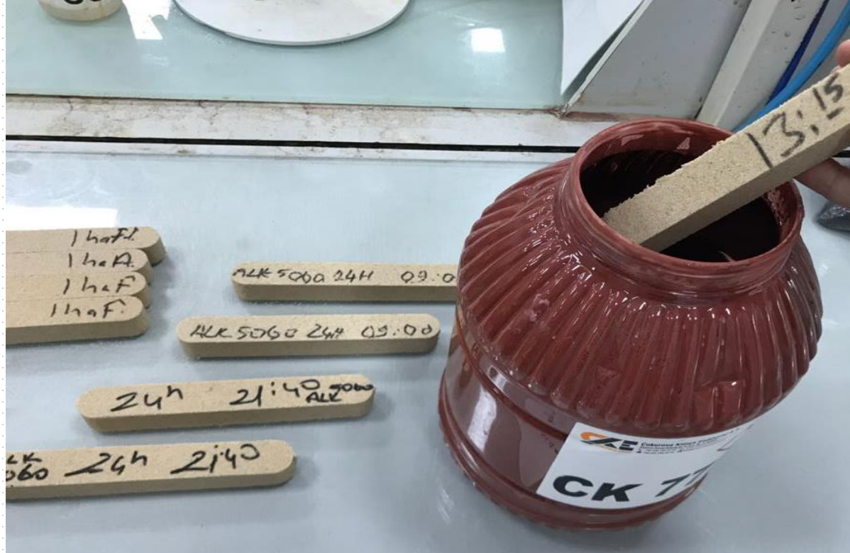
Alkafen maça numuneleri ve boyama işleminde kullanılan ÇK 782 A döküm boyası.
