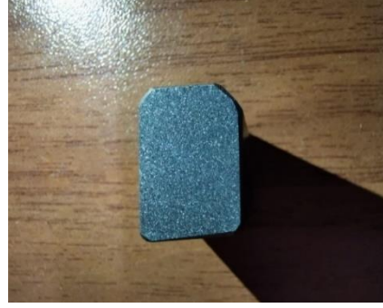
% 3 Nital ile uzun dağlanmış numune
