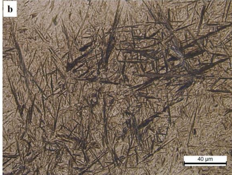
Şekil 2 HS numunesine ait genel (a) ve detay (b) mikro yapı görüntüleri
