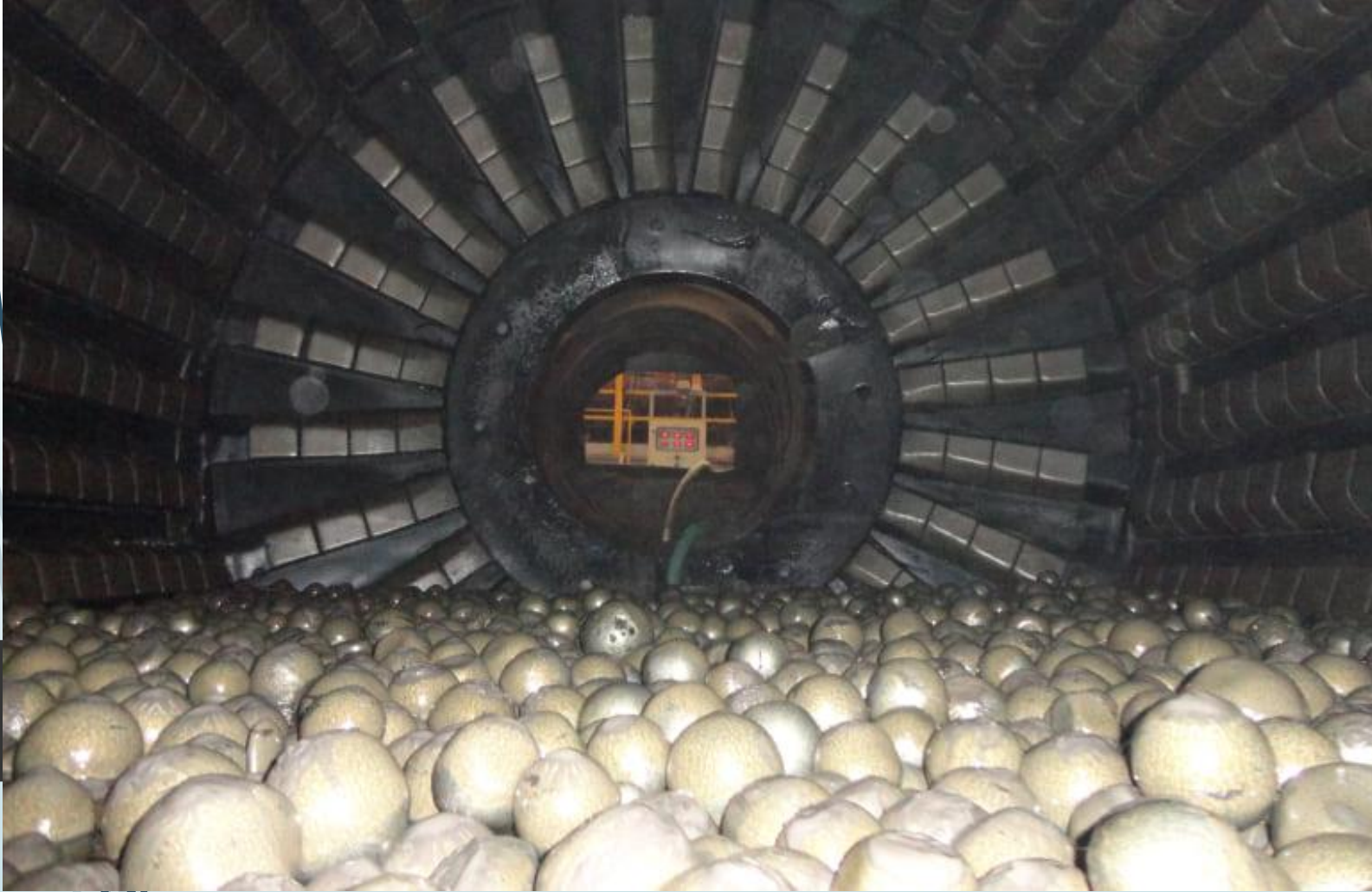
Öğütücü bilyeler ile doldurulmuş bir öğütme sistemi
