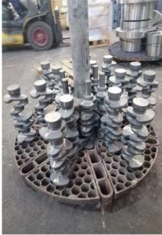
Şekil 9. Östemperleme Denemelerinde Parçalara Uygun İmal Edilen Aparat ve Parça Yerleşimi
