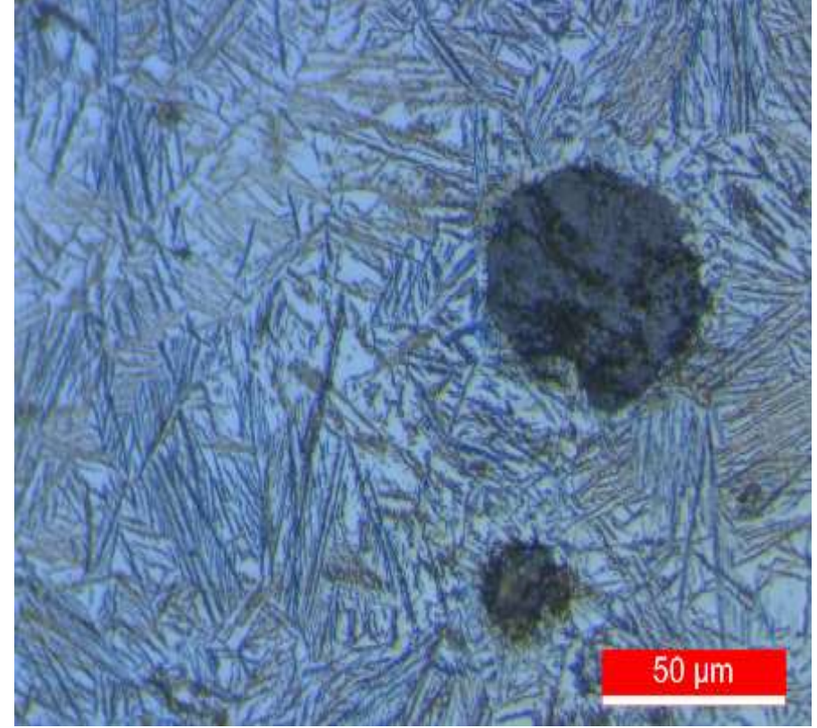
Şekil 16. 6 No'lu Krank Mili Numunesi Optik Görüntüsü (500X)
