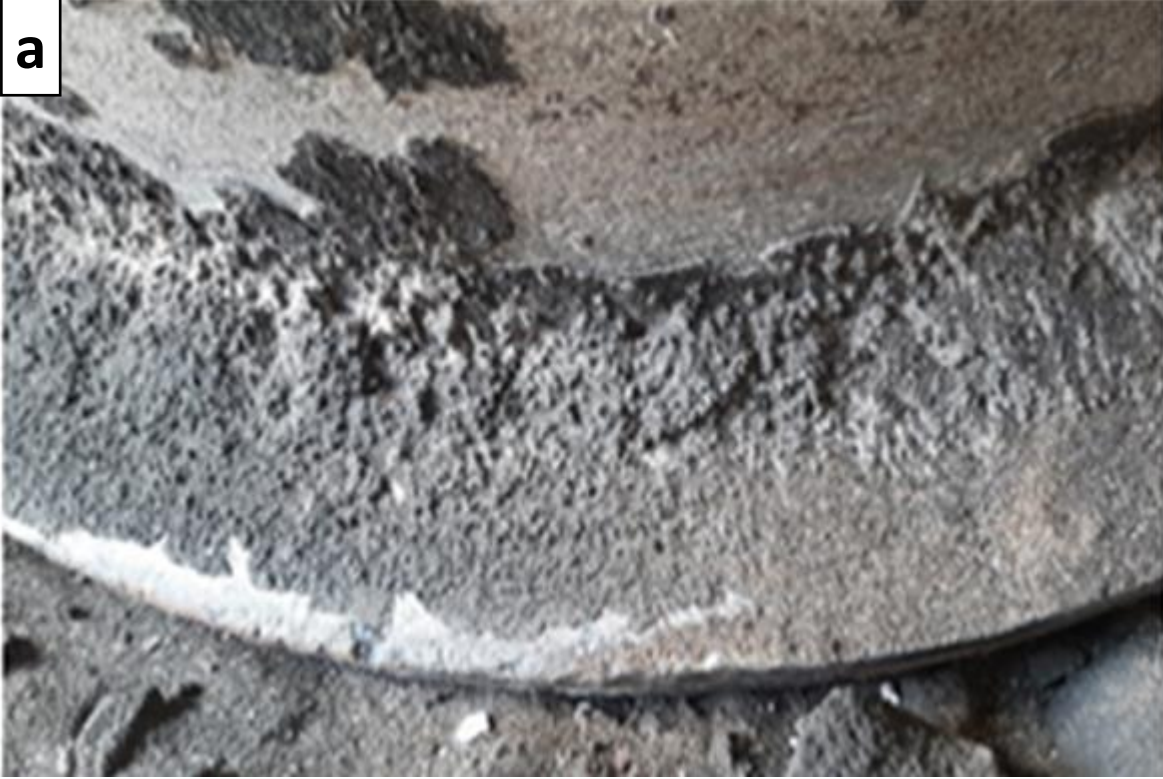
Şekil.4. Metal penetrasyon hataları
