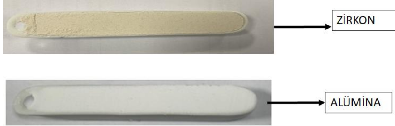
Şekil.6. Refrakter hammaddelerin 1450 °C'deki sinter görüntüleri
