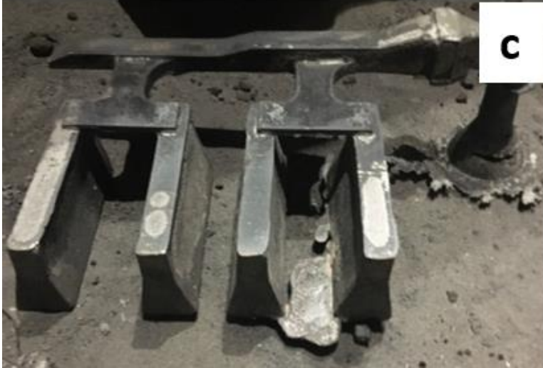
Numune bloklarının a) Kalıp, b) Döküm sonrası, c) Isıl işlem sonrası, d) Nihai görünüşleri.
