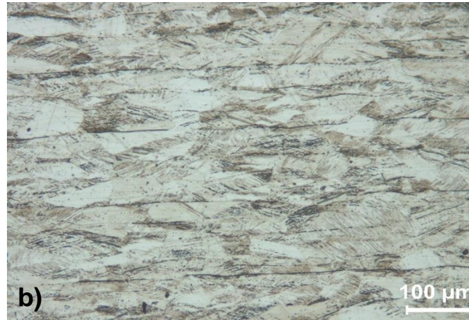
Şekil 5. Deformasyon öncesi (a), deformasyon sonrası (b) ve ImageJ analizi yapılmış optik mikroskop görüntüleri
