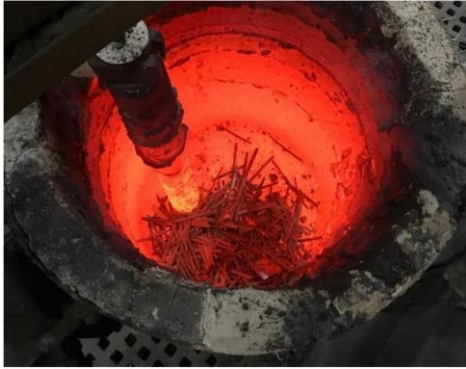
Şekil 4: Potada FeTi aşılama
